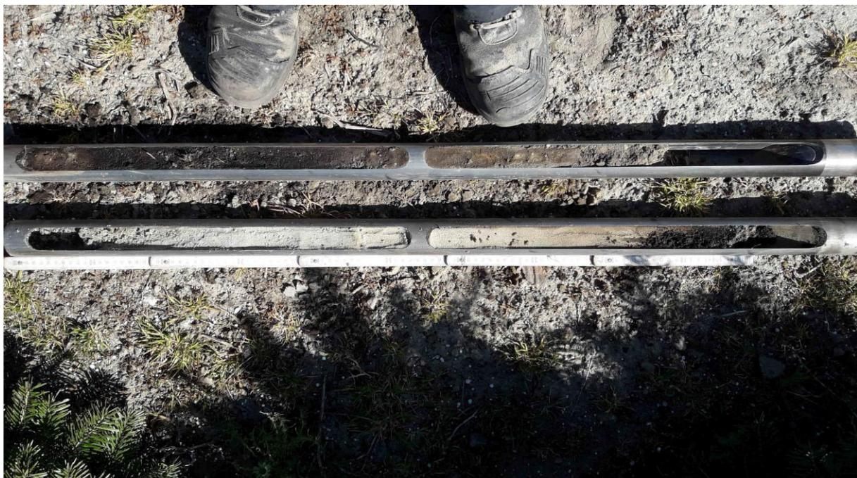
**Abb. 14:** Kerngewinn der Bohrung BP 4-1. Oben: 0-1 m u. GOK, unten: 1-2 m u. GOK. Deutlich sind die organischen Reste zwischen 0,55 und 0,90 m u. GOK zu erkennen.
