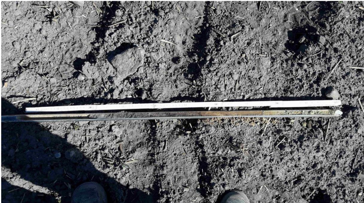
**Abb. 11:** Kerngewinn des Bohrprofils BP 1-1 von 0,0 - 1,0 m u. GOK
