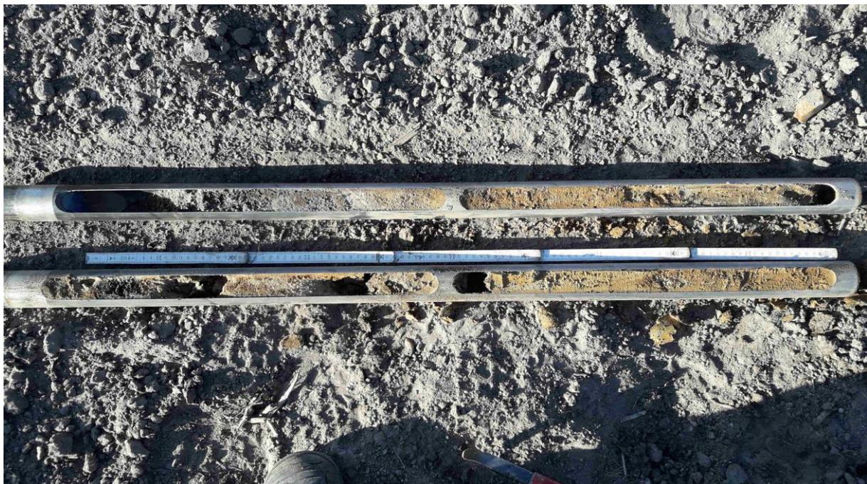
**Abb. 12:** Kerngewinn des Bohrprofils BP 2-1 im geplanten Fundamentbereich
