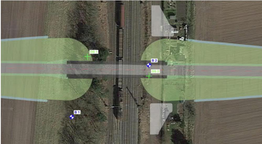
Abb.24: Lage der Aufschlüsse: Straßenbrücke (Quelle: Schnack Geotechnik)
