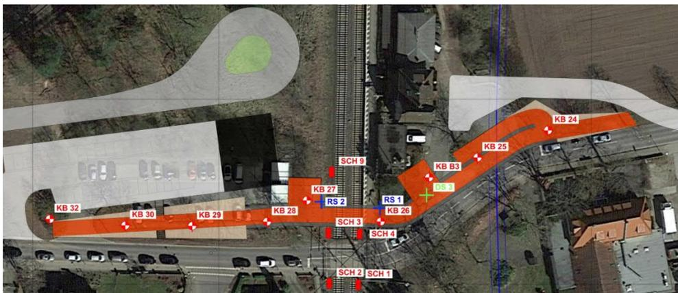
Abb.25: Lage der Aufschlüsse: Trogbauwerk (Quelle: Schnack Geotechnik)
