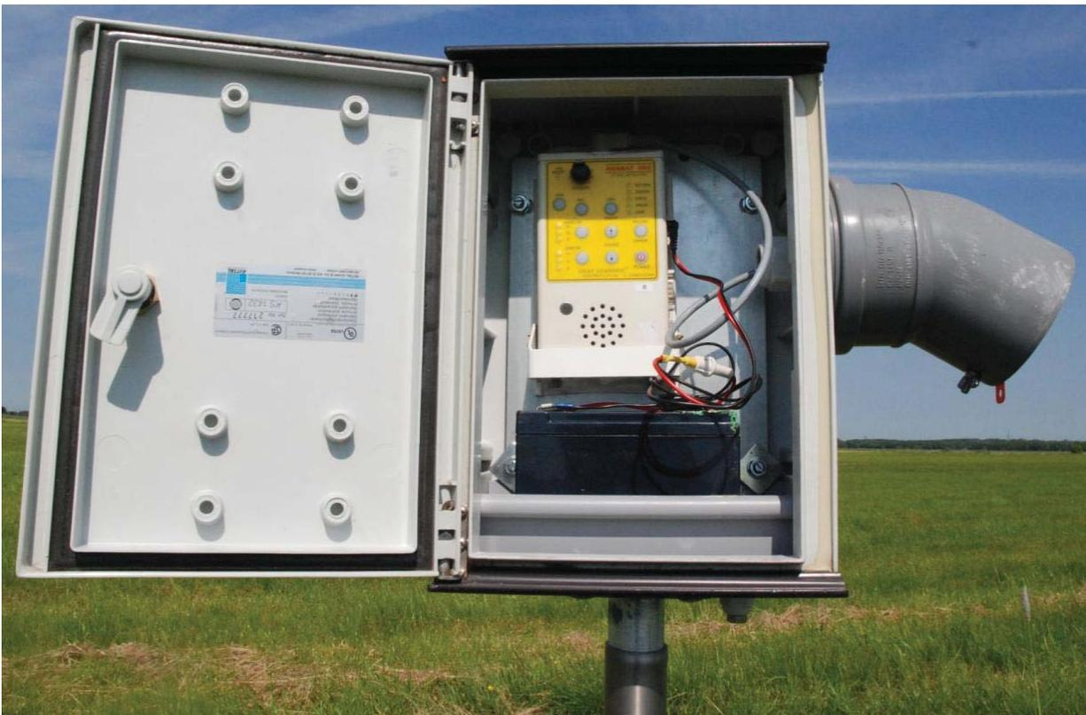
**Abbildung 4: Vorrichtung für die akustische Dauererfassung mit einem Anabat in Bodennähe (Innenansicht)**
