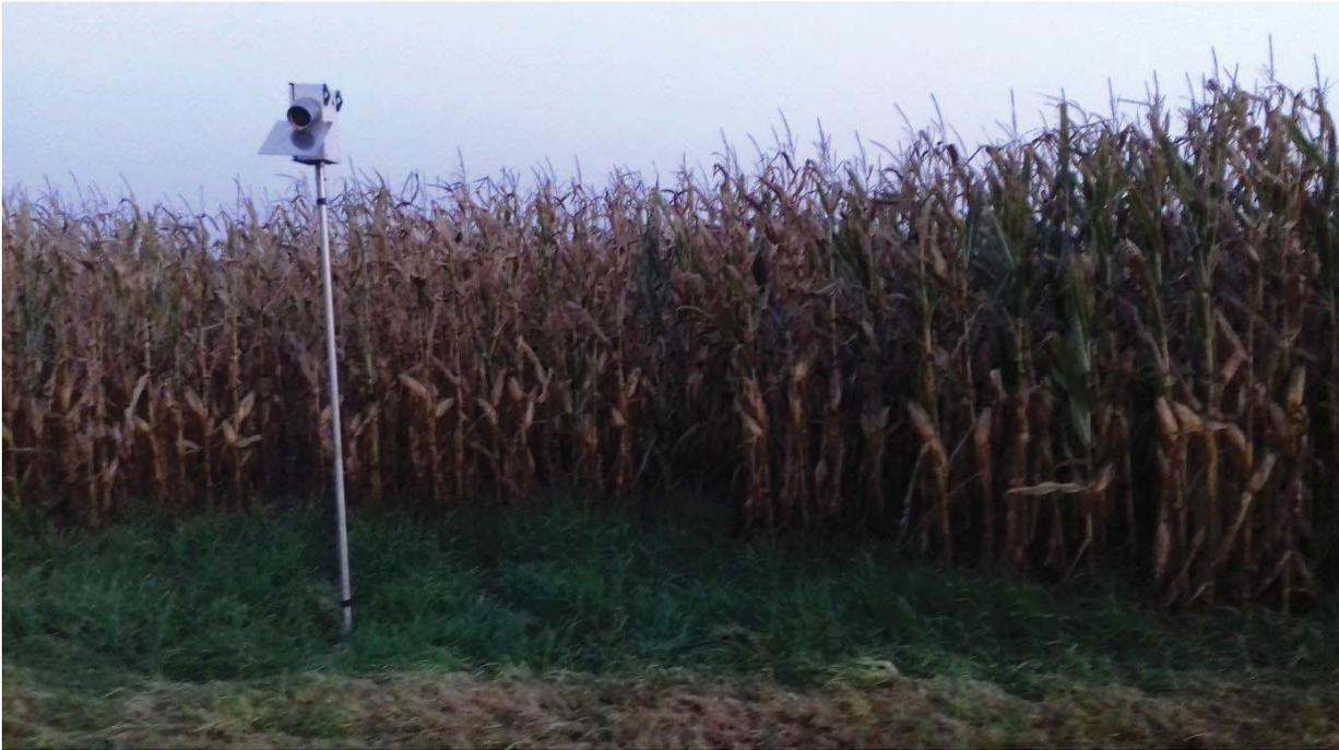
**Abbildung 3: Vorrichtung für die akustische Dauererfassung mit einem Anabat in Bodennähe (Außenansicht) im UG**
