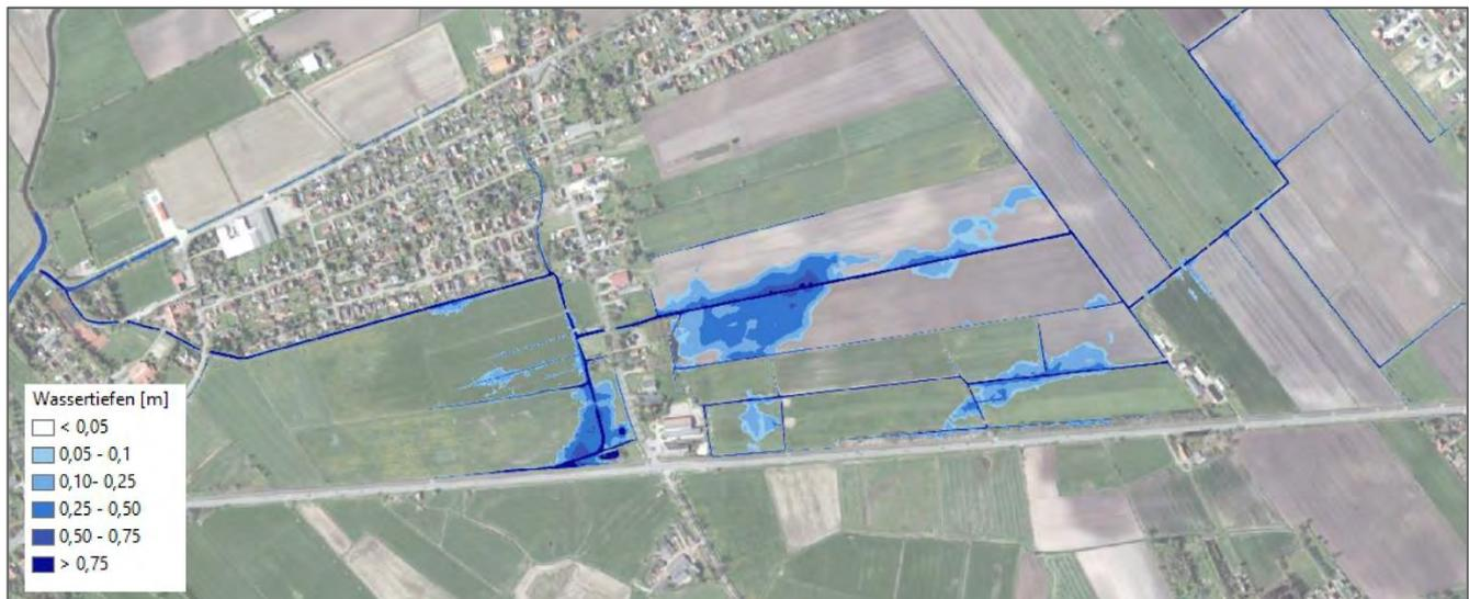
Abb. 12: Ausuferungen Hauptgewässer bei HQ100-Abfluss im Einzugsgebiet des Uthwerdumer Vorfluters
