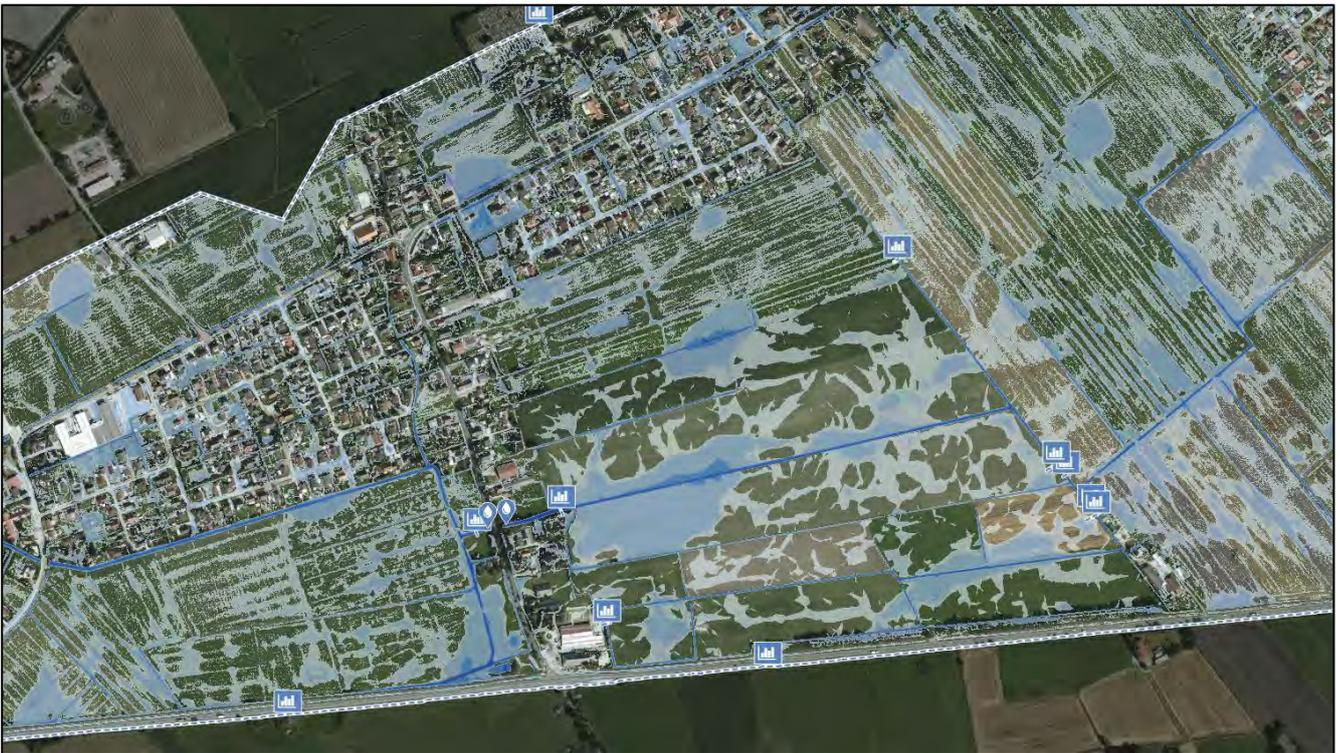
Abb. 13: Starkregensimulation (HQ100, 60 min) im Einzugsgebiet des Uthwerdumer Vorfluters (HYDROTEC 2021, Luftbilder www.lgln.de © 2017
