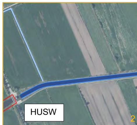
Abbildung 7-2: Wassertiefen Meedekanal Bestand – Hydraulische Berechnung HQ100
