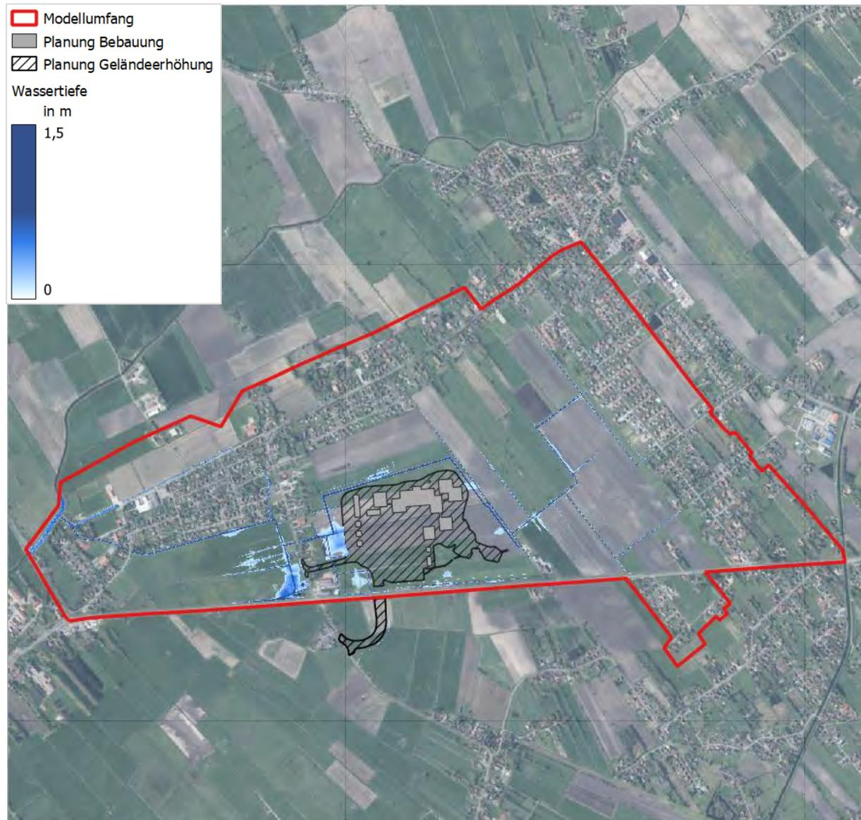
Abbildung 7-6: Wassertiefen Uthwerdumer Vorfluter Planzustand 1a – Hydraulische Berechnung HQ100
