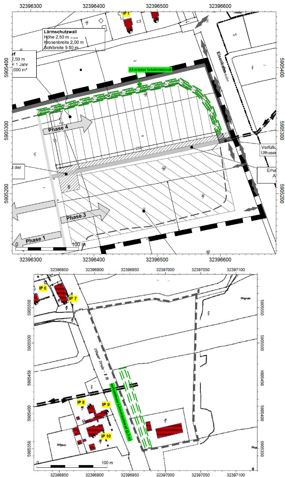
Abbildung 12: Lagepläne der in den Prognosen berücksichtigten Schallschutzwälle (grün gestrichelt, Höhe jeweils 2,5 m). Obere Abbildung: Position am nordöstlichen Rand des Abbaubereiches. Untere Darstellung: Position am südwestlichen Rand des Betriebsgeländes.
