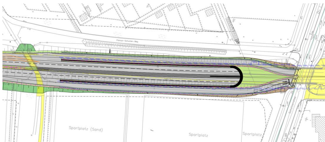
Abbildung 60: Neubau Ein- und Ausfahrrampen westlich der Schützenallee
