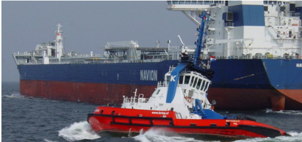
Abb. 104: Escort Schlepper im Einsatz an einem Tanker 137
