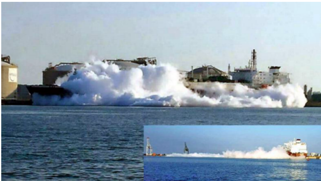
Abb. 3: Unbeabsichtigter LNG Austritt auf der Fuwairit im Hafen von Barcelona 8
