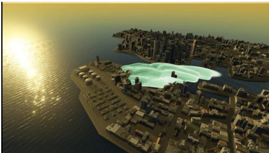
Abb. 87: Simulierter Austritt von LNG mit FLACS-CFD 106
