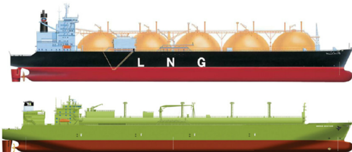
Abb. 5: Kvaerner Moss Design (oben), Membrandesign (unten)
