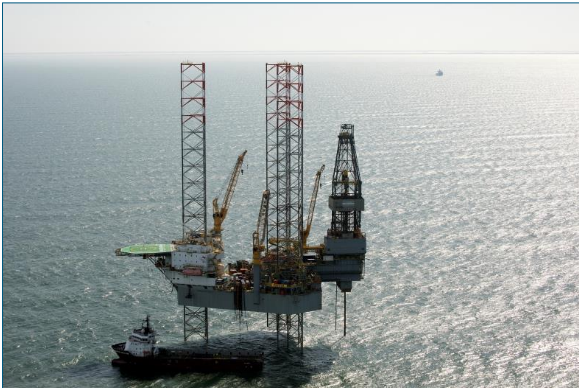
Abbildung 2- 45: Selbsthebende Bohranlage am Standort der Plattform N07-04A (2018). Die Bohranlage befindet sich auf der rechten Seite der Plattform. (© Foto & Video Honey)
