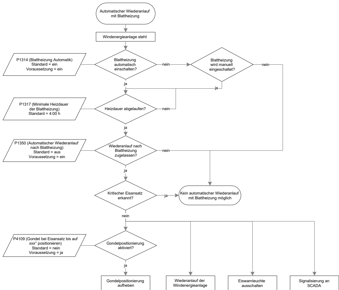
Abb. 3: Automatischer Wiederanlauf mit Blattheizung
