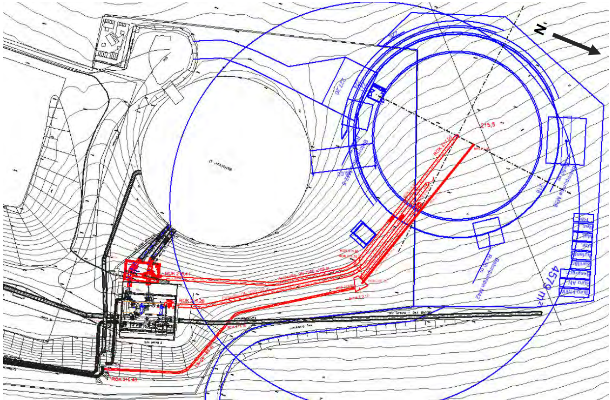
Abb. 23 Variante A: Lageskizze mit Rohrleitungen und Schachtbauwerken
