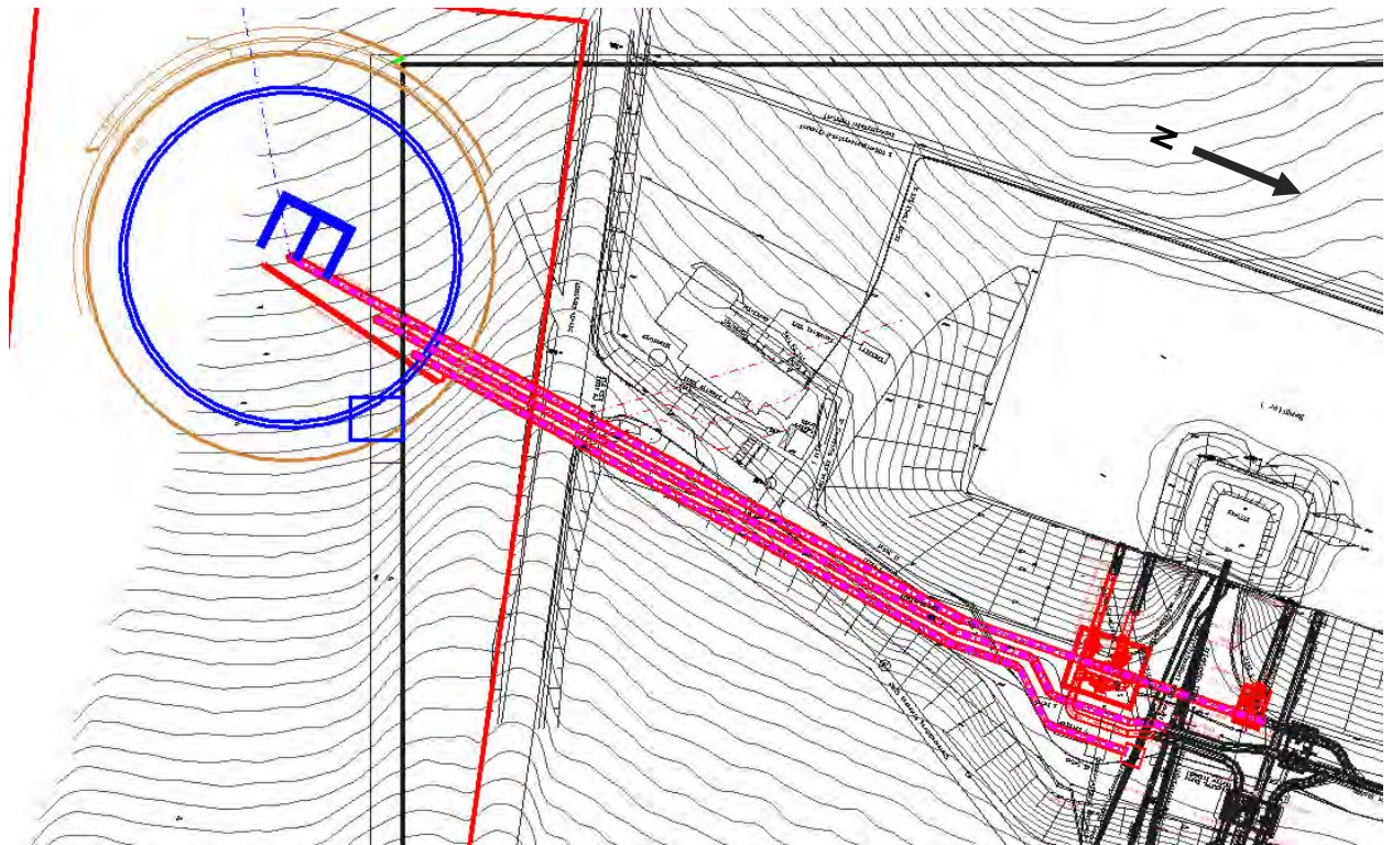
Abb. 26 Variante E: Lageskizze mit Rohrleitungen und Schachtbauwerken
