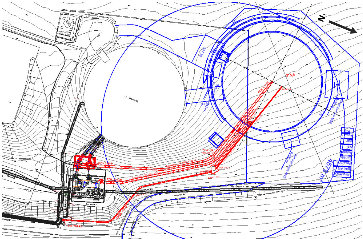
Abb. 23 Variante A: Lageskizze mit Rohrleitungen und Schachtbauwerken
