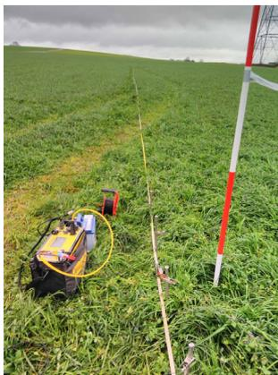
Die geoelektrischen Messungen erfolgten in Form von 1 D - Widerstandsmessungen nach der Wenner – Konfiguration mit Elektrodenabständen  $a$  von 0,5, 1, 2, 3, 5, 8, 12, 16, 20, 25 und 30m. Die Widerstandswerte wurden durch die Messung von mindestens 2 Messzyklen ermittelt.
