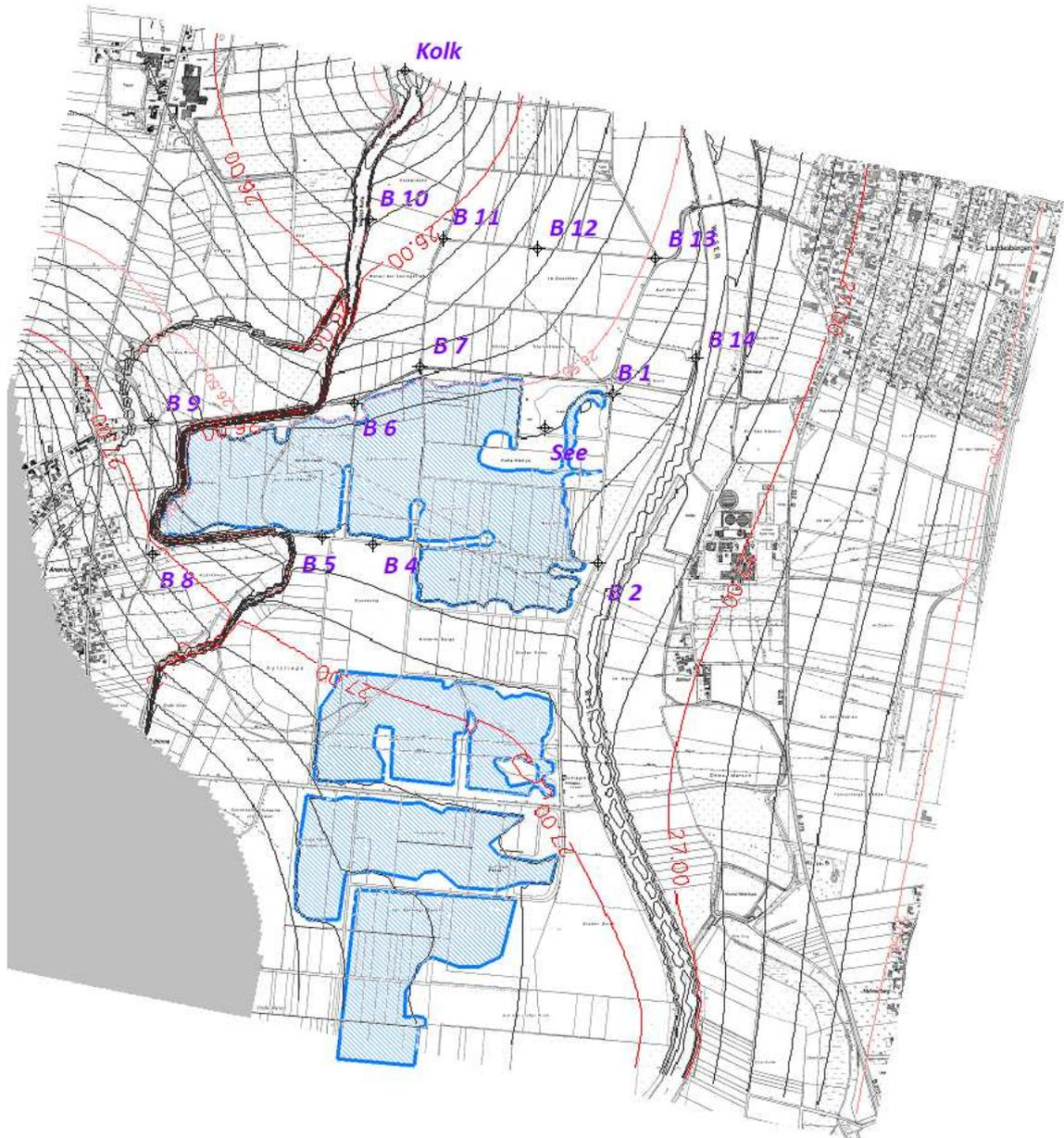
Abbildung 3-4: Grundwasserstände nach Realisierung Abbauabschnitt 15
