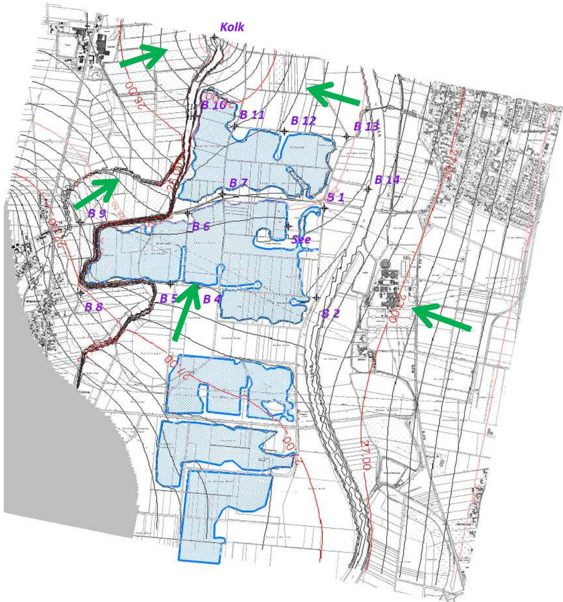
Abbildung 3-6: Grundwasserstände nach Realisierung des Gesamtabbaus
