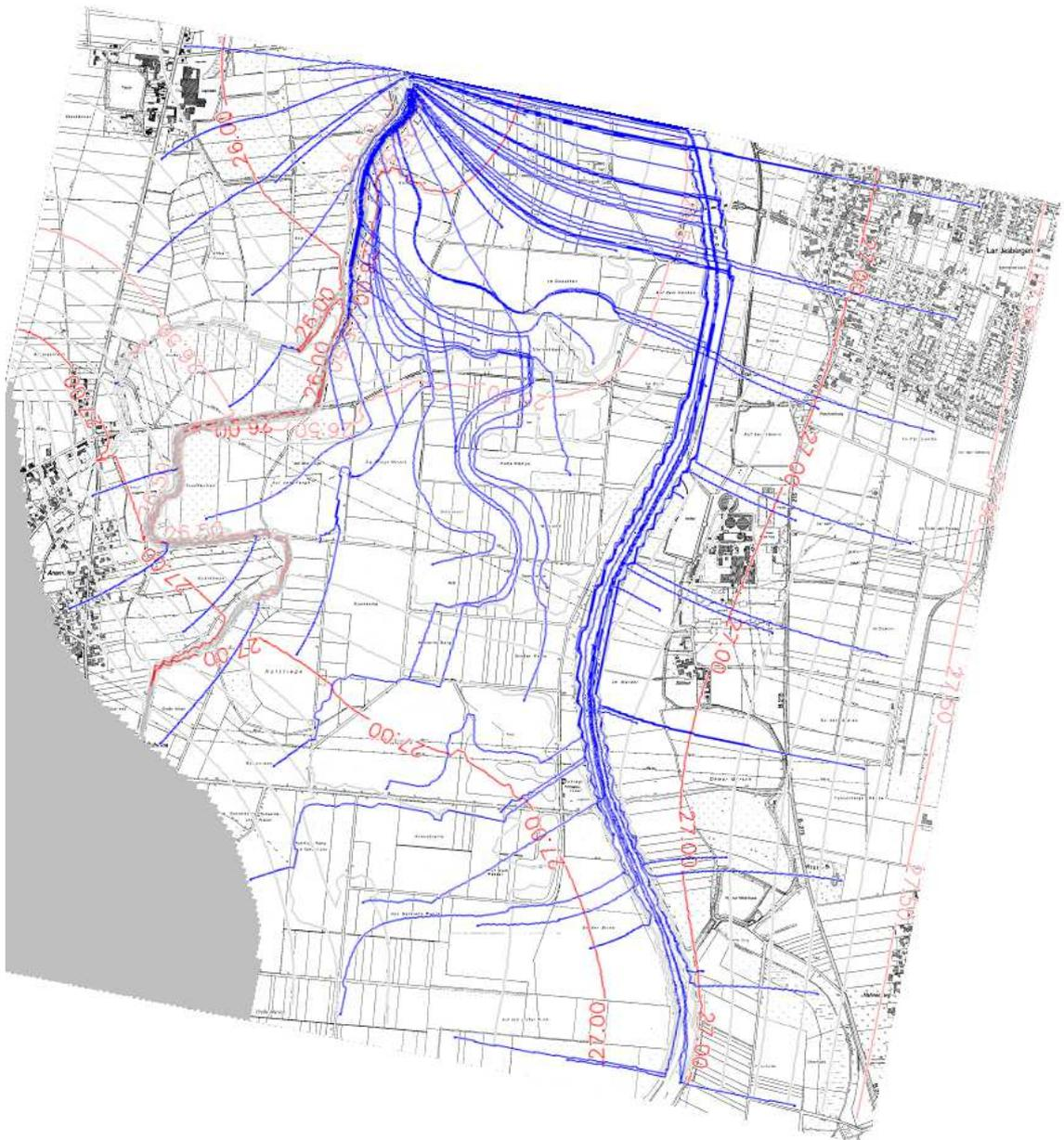
Abbildung 3-8: Grundwasserstromlinien im Zustand nach Realisierung des gesamten Abbaus
