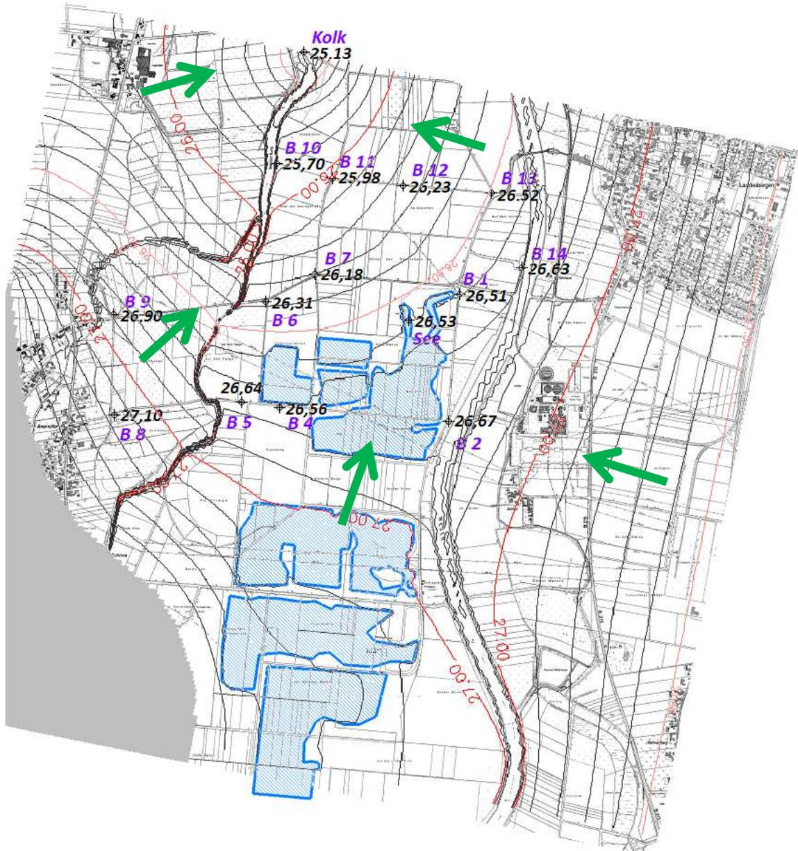
Abbildung 2-2: Errechnete Grundwasserstände im vorhandenen Zustand
