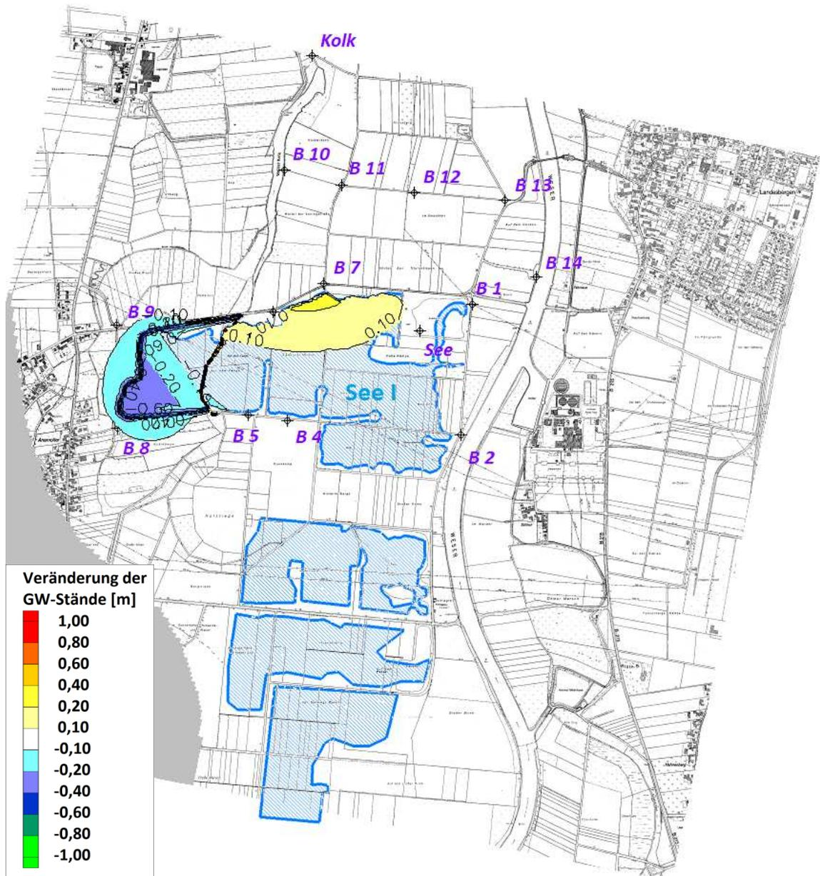
Abbildung 3-5: Veränderungen der Grundwasserstände nach Realisierung Abbaubereich 15
