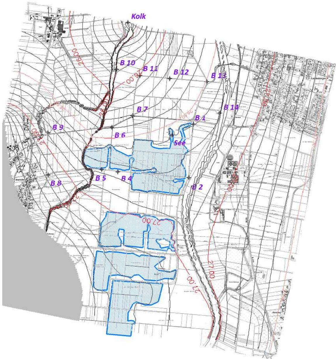
Abbildung 3-2: Grundwasserstände nach Realisierung Abbauabschnitt 4
