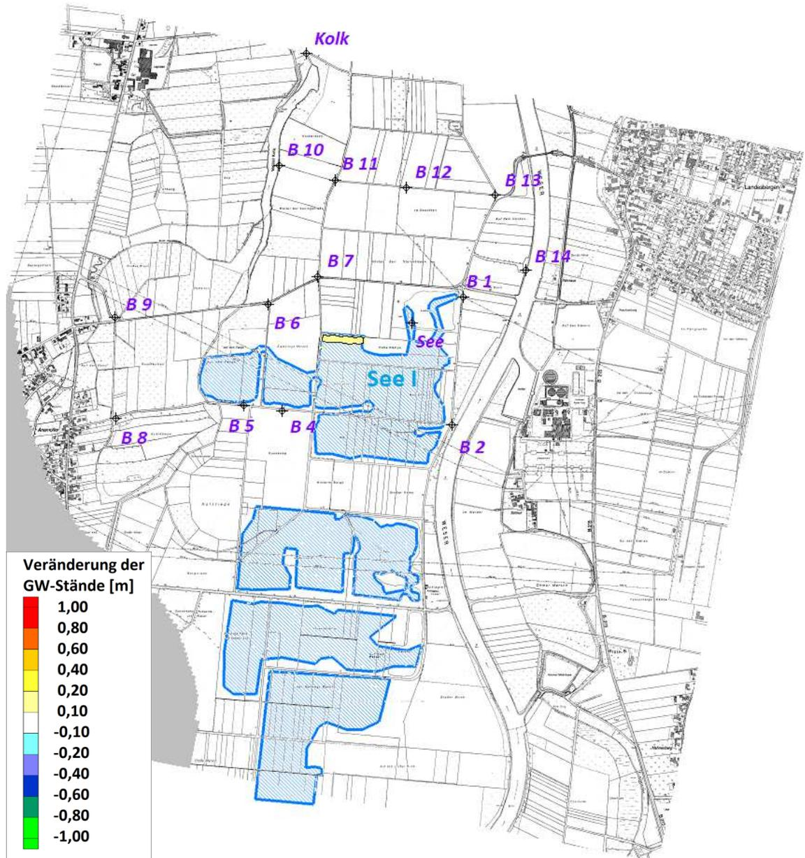
Abbildung 3-3: Veränderungen der Grundwasserstände nach Realisierung Abbaubereich 4
