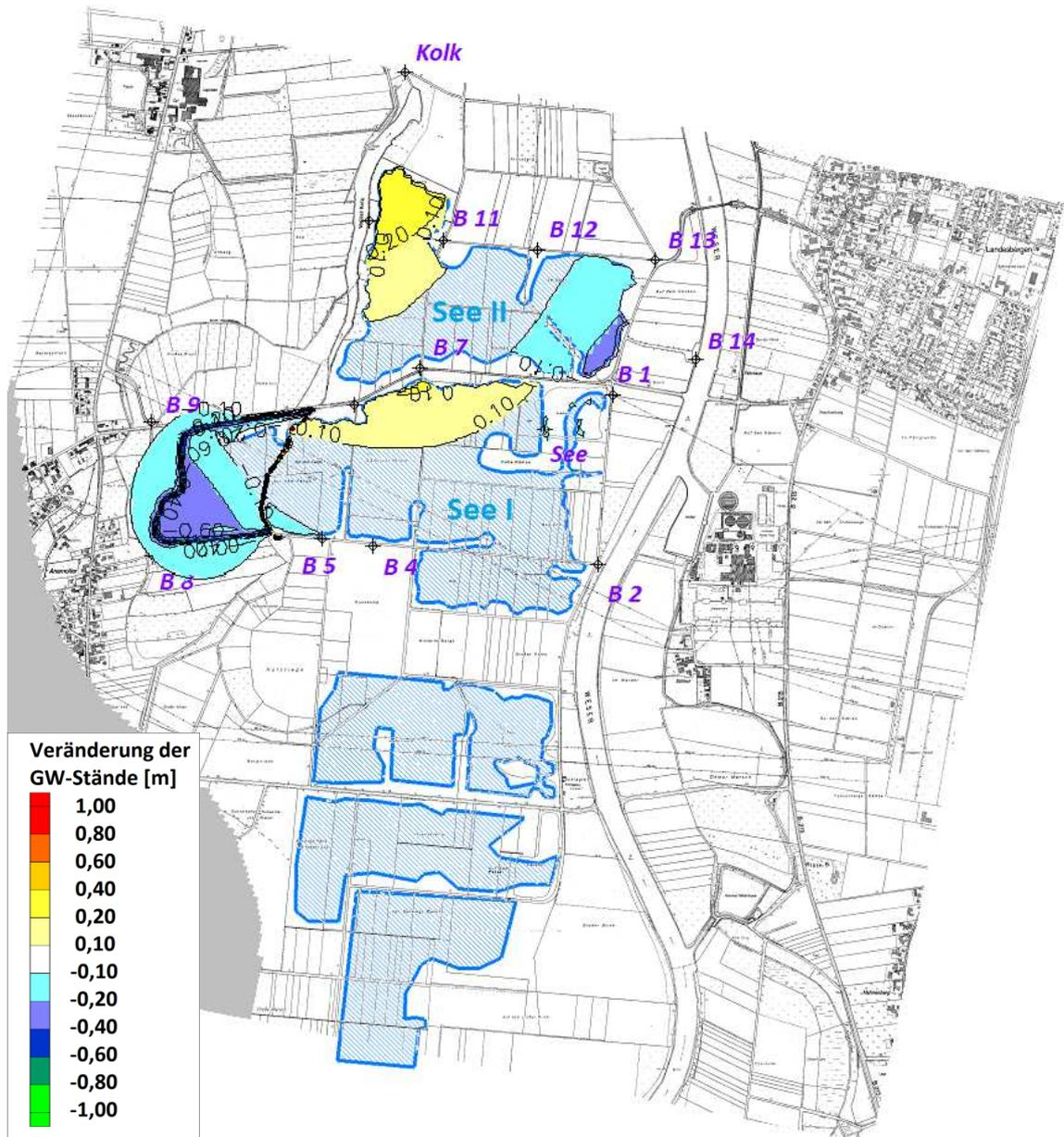
Abbildung 3-7: Veränderungen der Grundwasserstände nach Realisierung des gesamten geplanten Abbaus
