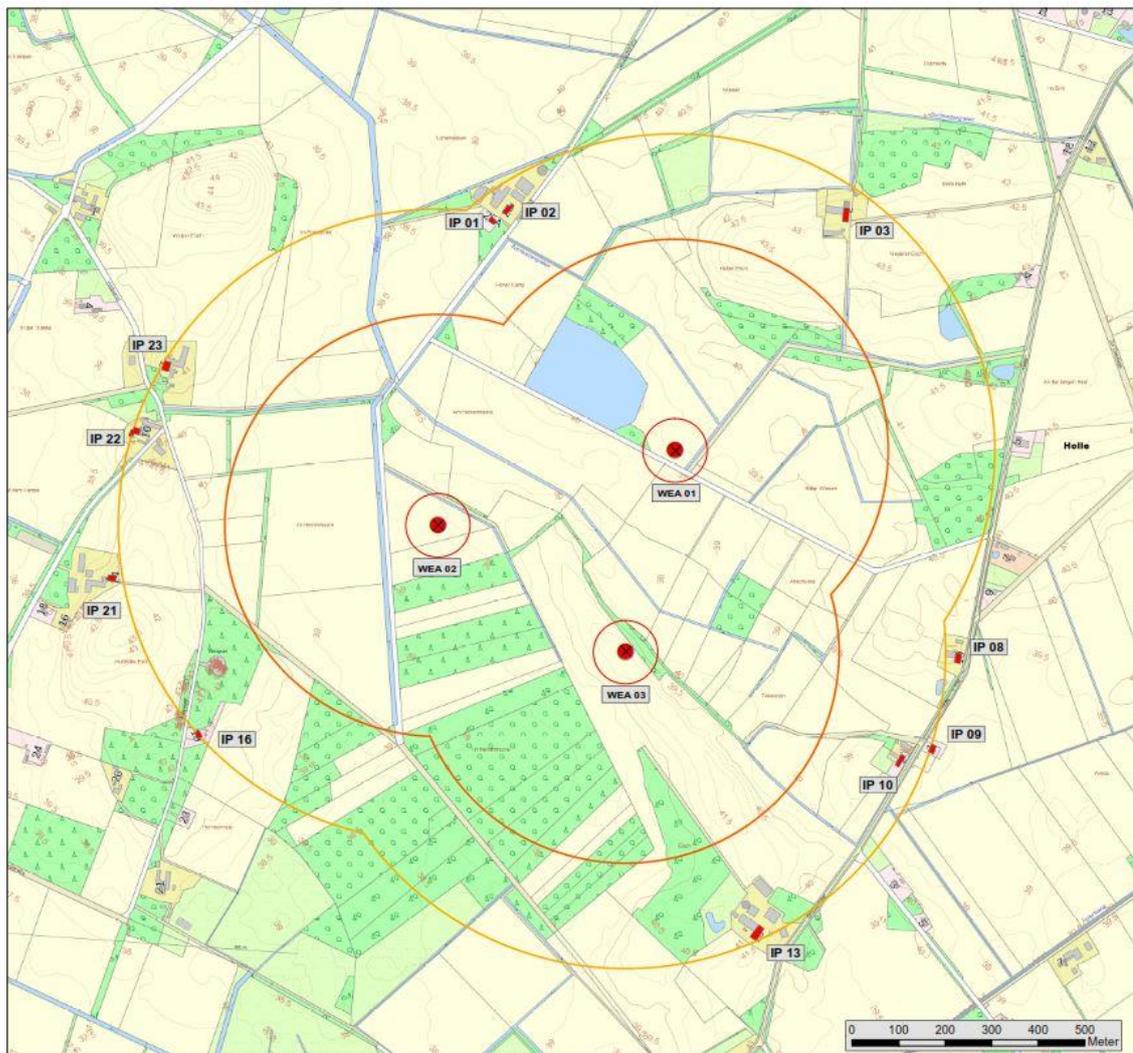
Abb. 26 Lage der umliegenden Wohngebäude zum geplanten Windpark gemäß Gutachten zur Opt. Bedr. Wirkung (gelbe Linie entspricht 3-facher Anlagenhöhe, orange Linie entspricht 2-facher Anlagenhöhe) (Dense und Lorenz, 2018)
