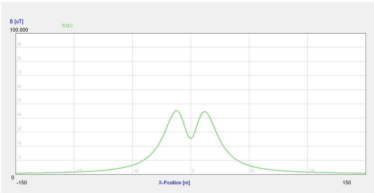
Magnetische Flussdichte für 1,0 m über Boden im Nachweisbereich entsprechend LAI-Hinweise
