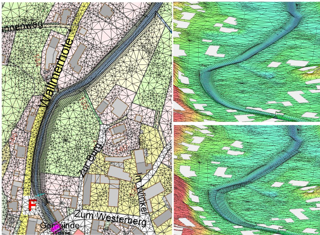
Abbildung 4-5: Hydraulisches Modell der Neile in Neuwallmoden im Unterwasser der Brücke „Zum Westerberg“; links Lageplanansicht PLAN, oben rechts IST-Zustand, unten rechts PLAN-Zustand
