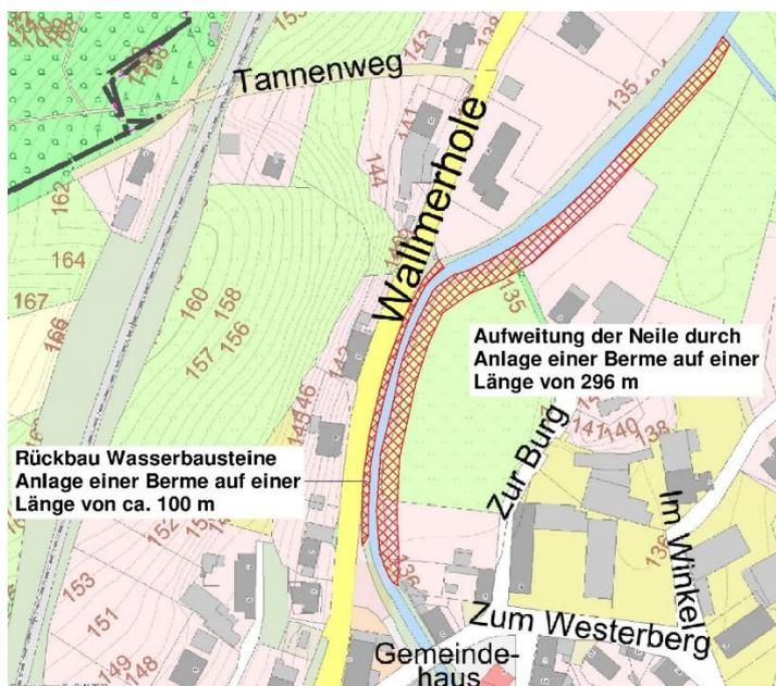
**Abbildung 3:** Übersichtsplan mit Variante zur Aufweitung der Neile unterhalb der Brücke im Zuge der Straße „Zum Westerberg“
