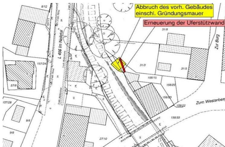
**Abbildung 4:** Abbruch des in die Neile ragenden Gebäudes „Zum Westerberg 1“ einschl. der Gründung
