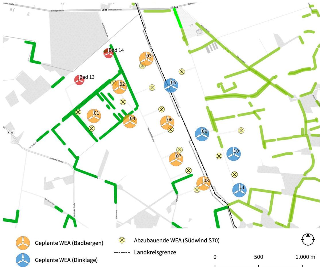
**Abbildung 20** Wallhecken im Nahbereich des Vorhabens. Wallhecken im Landkreis Osnabrück in dunkelgrün, Wallhecken im Landkreis Vechta in hellgrün, von der UNB nachkartierte Wallhecken in neongrün
