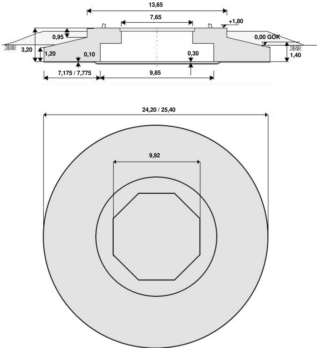
*Abb. 1 Schematische Darstellung eines exemplarischen Fundamentes für eine N149/4.0-4.5 mit 164 m Nabenhöhe (alle Angaben in Metern, Skizze nicht maßstabsgerecht)*
