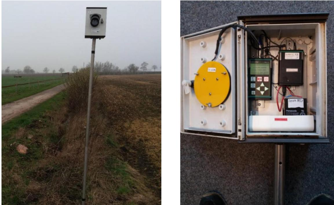
**Abb. 2: Vorrichtung für die akustische Dauererfassung mit einem Batcorder in Bodennähe – Außenansicht und Innenansicht**
