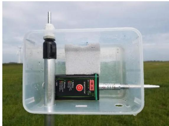
**Abb. 3: Aufbau der Mini-Batcorder-„Horchkisten“ im Gelände**
