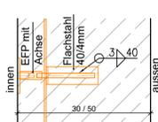
**Anschluss EFP (Aussen-Grundriss)**
