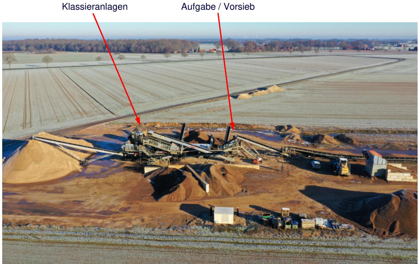
Die Schallemissionen der Aufbereitungsanlagen wurden an insgesamt fünf Ersatzmesspunkten in jeweils 43 m bis 48 m Abstand von der Mitte der geräuschrelevanten Anlagen ((Aufgabe Vorsieb und Klassieranlagen) gemessen. Die Schalleistungspegel wurden dann durch Rückrechnung nach der Norm DIN ISO 3613-2 mit einem akustischen EDV-Modell ermittelt.
