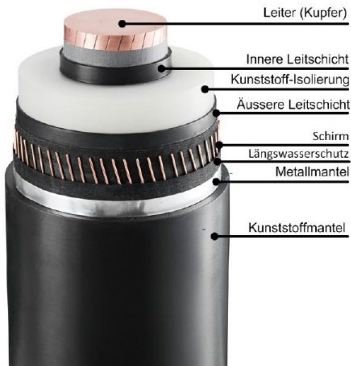
Abbildung 2: Querschnitt eines VPE-Kabels.
