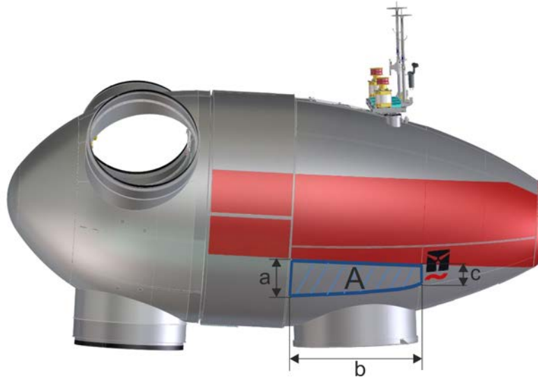
Abb. 4: Gondelverkleidung E-82 E2, E-82 E4, E-92, E-103 EP2 aus Aluminium, mit Tageskennzeichnung DTM-03
