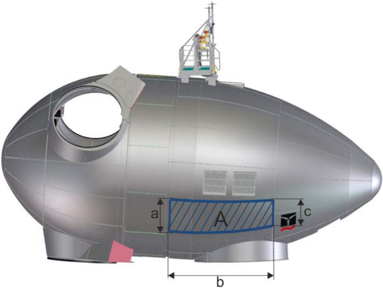
Abb. 21: Gondelverkleidung E-126 EP4, E-141 EP4 aus Aluminium, ohne Tageskennzeichnung
