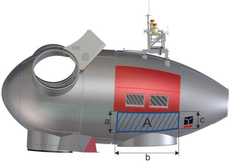
Abb. 6: Gondelverkleidung E-101, E-101 E2, E-115, E-115 E2 aus Aluminium, mit Tageskennzeichnung DTM-02
