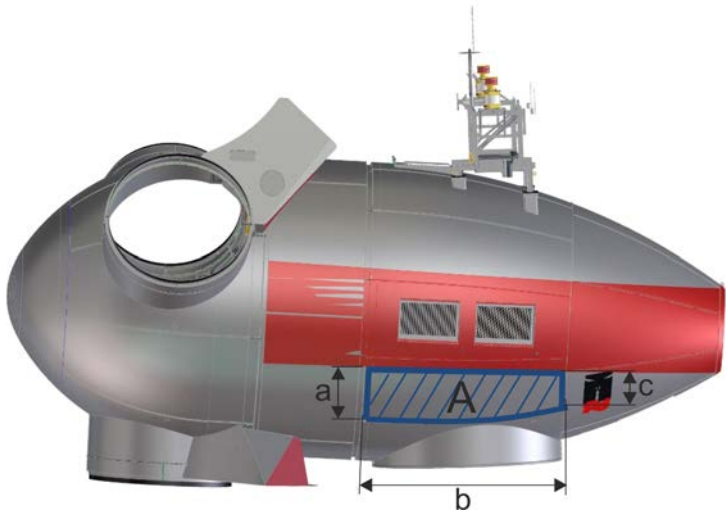
Abb. 7: Gondelverkleidung E-101, E-101 E2, E-115, E-115 E2 aus Aluminium, mit Tageskennzeichnung DTM-03
