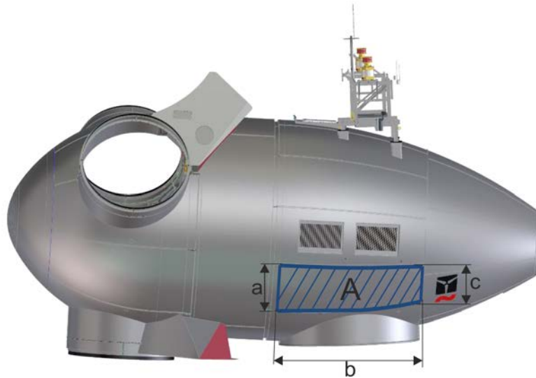
Abb. 8: Gondelverkleidung E-101, E-101 E2, E-115, E-115 E2 aus Aluminium, ohne Tageskennzeichnung
