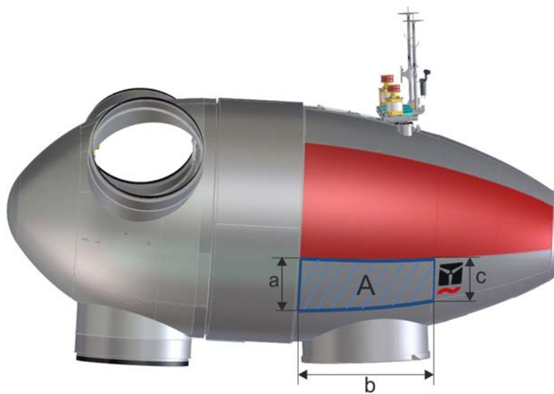
Abb. 5: Gondelverkleidung E-82 E2, E-82 E4, E-92, E-103 EP2 aus Aluminium, mit Tageskennzeichnung DTM-01
