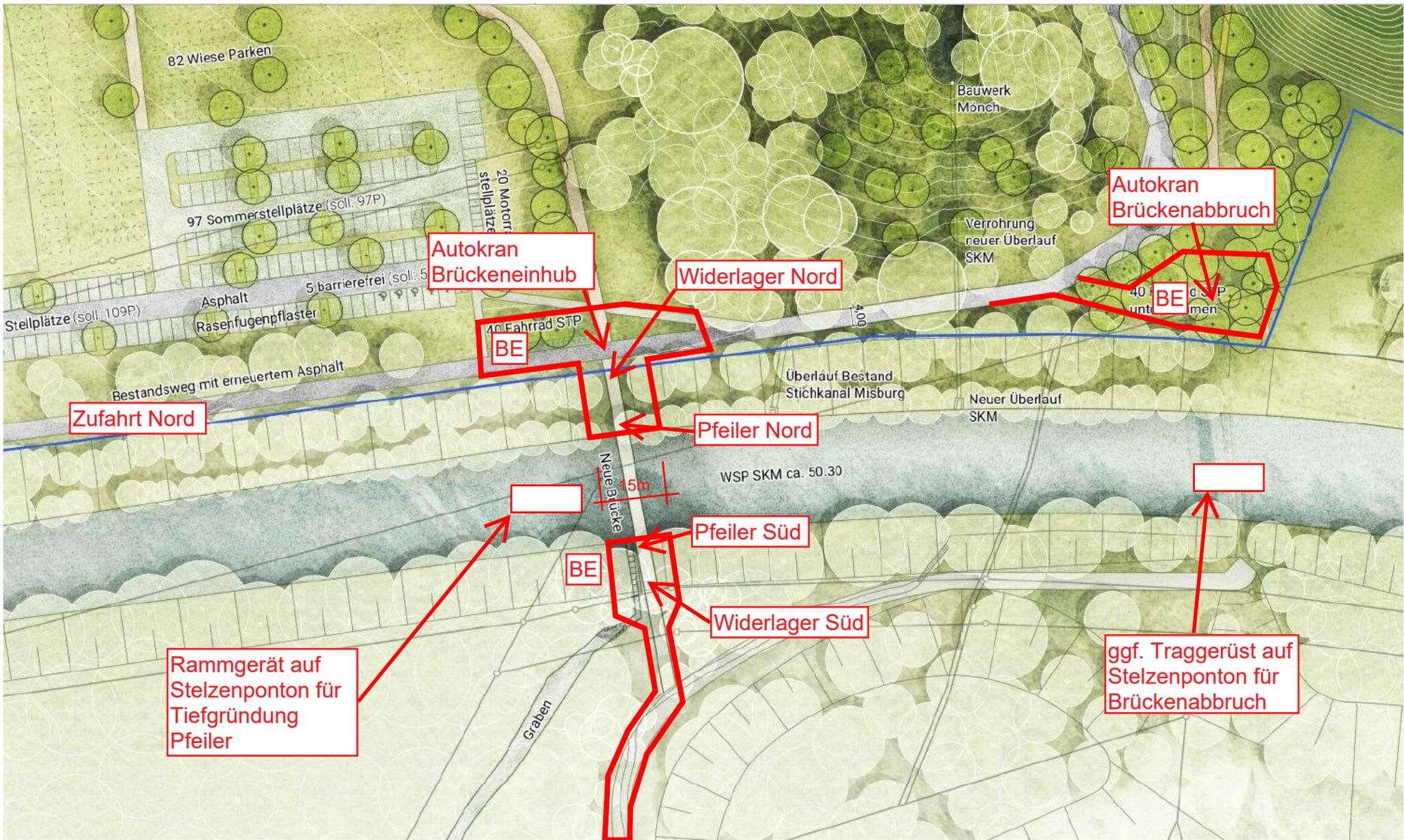
Umschlagstelle am Kanal für Anlieferung der Großgeräte (Ramme) und für Baustoffe der beiden Pfeiler erforderlich.
