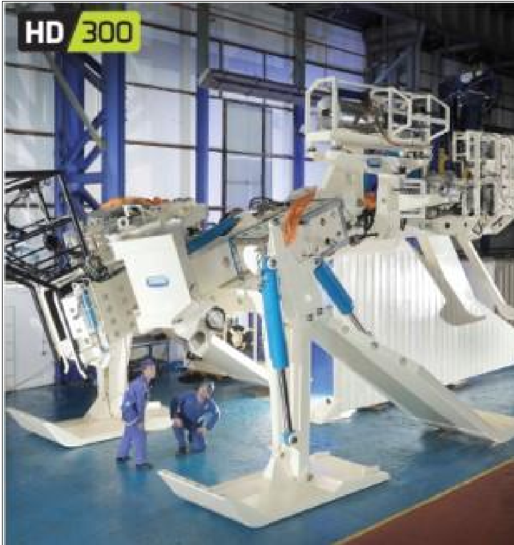
Abbildung 17: Heavy Duty Plough (HDP) (Quelle: SMD)
