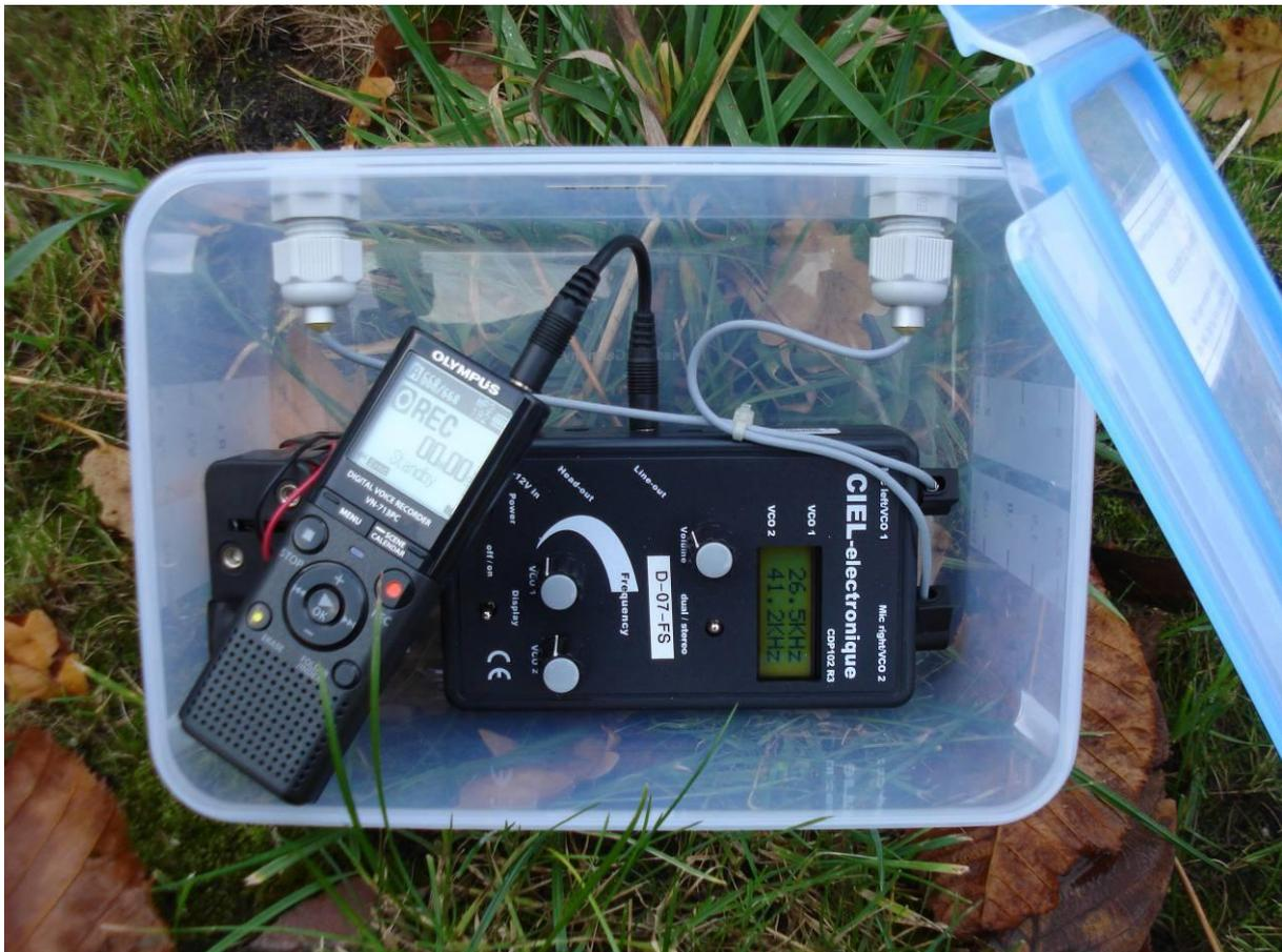
**Abbildung 1: Schematischer Aufbau einer Horchkiste**
