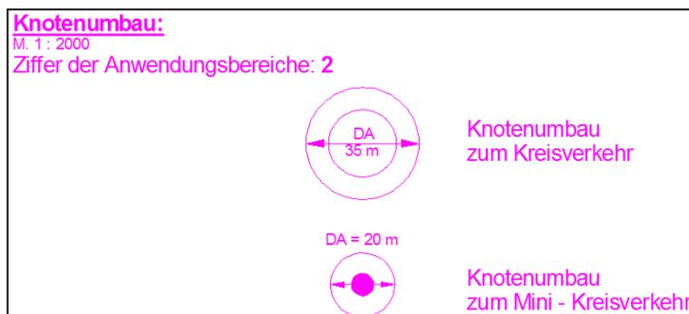
Abb. 13: Geschwindigkeitsdämpfende Maßnahmen in Ortsdurchfahrten -Knotenumbau- (Ziffer 2)
