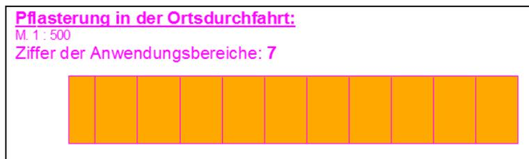
Abb. 19: Geschwindigkeitsdämpfende Maßnahmen in Ortsdurchfahrten -Pflasterung in Ortsdurchfahrten- (Ziffer 7)
