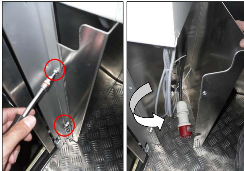
Verwenden Sie einen Schraubendreher für den Ausbau der beiden Schrauben, die in der Nähe der Türseite angebracht sind. Wenn beide Schrauben ausgebaut sind, können Sie die Abdeckung abnehmen.
