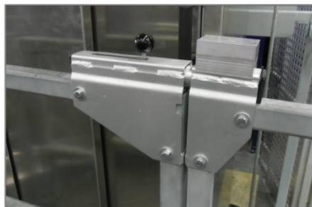
Drücken Sie den Schieber hinein und wenden weiterhin einige Kraft an. Drehen Sie den Schlüssel um 90° im Uhrzeigersinn, um die Tür zu verriegeln. Der Schlüssel kann nun von der Tür entfernt werden.
