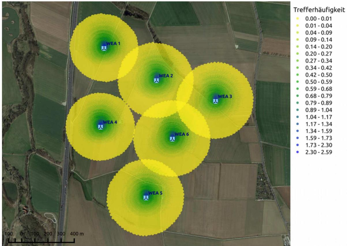
*Abbildung A.1.3: Trefferhäufigkeiten von Eisstücken pro Rasterfläche (16m<sup>2</sup>) und Jahr in der Umgebung der WEA 1 - 6 am Standort Bornhausen (Satellitenbild /13/).*
