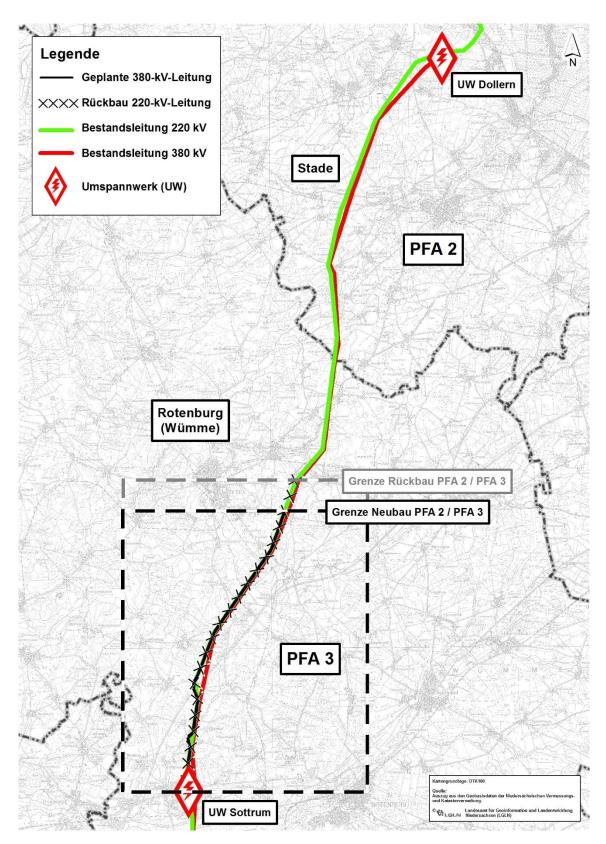
Abbildung 1: Lage der beantragten 380-kV-Leitung LH-14-311 und Rückbau der 220-kV-Leitung (LH-14-2142) im Planfeststellungsabschnitt (PFA) 3
