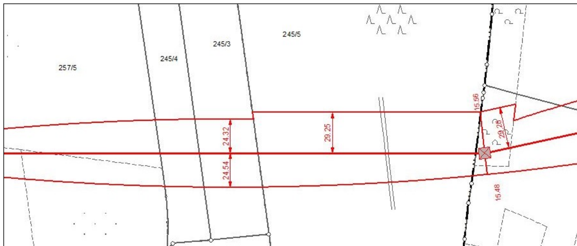
Abbildung 8: Beispiel parabolischer und paralleler Schutzstreifen einer Freileitung
