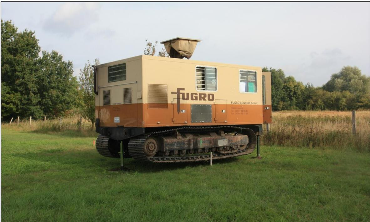
**Abb. 9-2: Einsatz der Drucksonde mit Leitfähigkeitsmessung im Untersuchungsgebiet**
