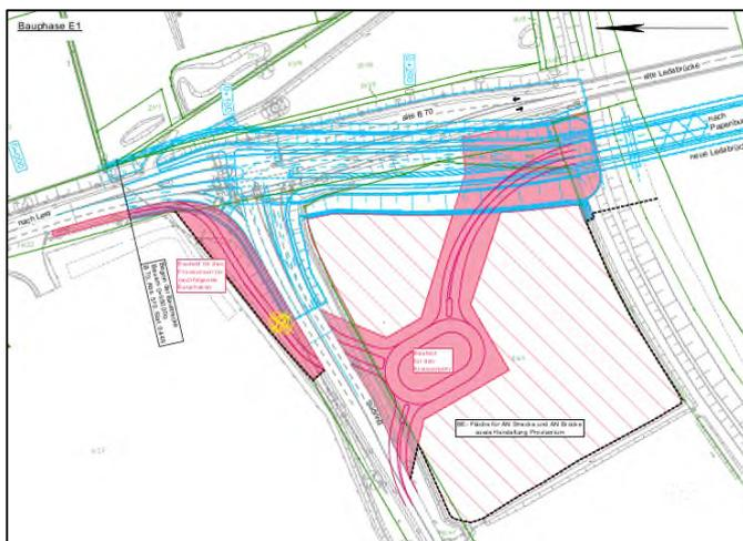
Abbildung 8: Lageplan Bauphasenplan Nord, Bauphase E1
