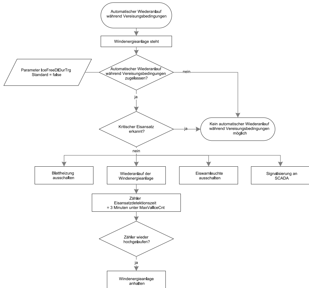
Abb. 2: Automatischer Wiederanlauf während Vereisungsbedingungen
