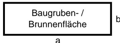
Die Brunnenfläche ist die Fläche, die von den am Baugrubenrand angeordneten Absenkungsbrunnen eingeschlossen wird.
