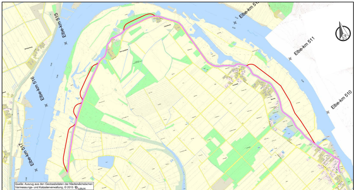
Abb. 8-1: Bestehende Deichlinie und schematische Darstellung der Vordeichung (unmaßstäblich, Darstellung: NLWKN).
