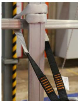
1 Steigschutzschiene Hailo®, unmittelbar über einem Leiterverbinder. Dieser Anschlagpunkt ist für ein Höhensicherungsgerät, mitlaufendes Auffanggerät oder für das Rettungsgerät zu verwenden. Hierzu ist eine Bandschlinge 2 m entsprechend *PSA-Liste Absturz und Rettung* zu nutzen.
