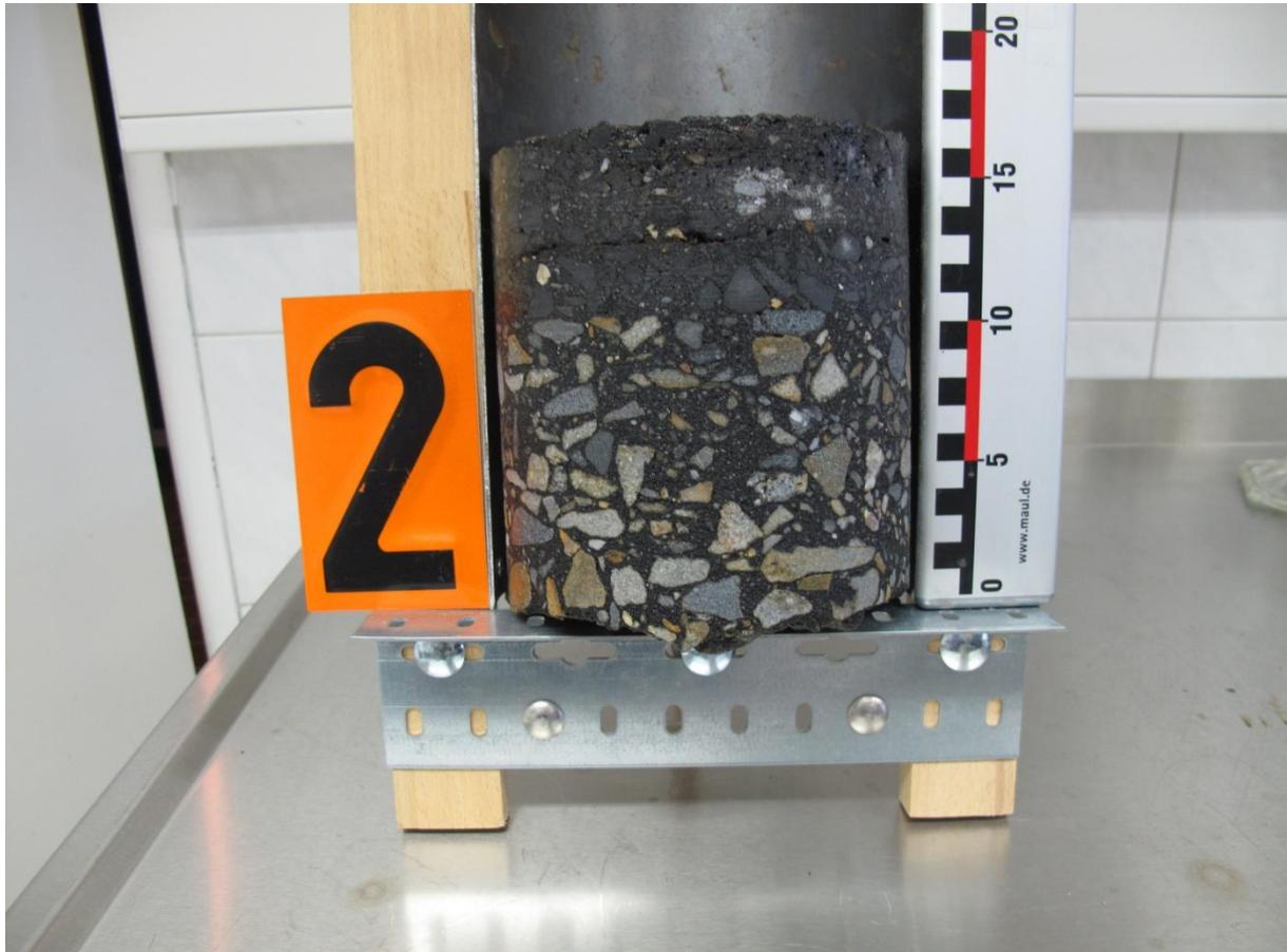
Bild 6 Asphaltbohrkern BK 02 westlich der Asphaltstichtfuge
