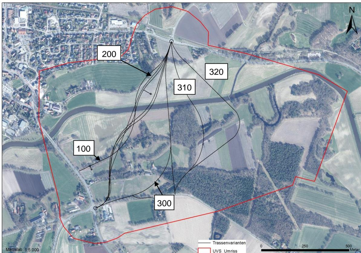
**Abbildung 2:** Lage des Untersuchungsgebiets und die verschiedenen Trassenvarianten und Untervarianten (10/20) der Trasse 300 (unmaßstäblich). Quelle: LGLN 2018 ©
