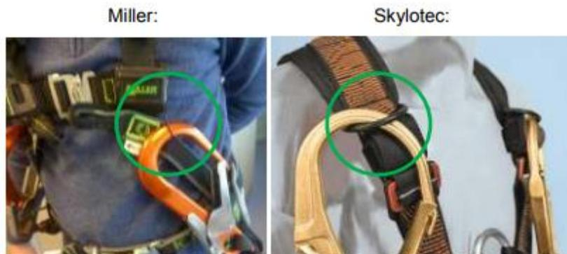
Abbildung 9-6: Befestigung der Ankerverbindung am Auffang- und Rettungsgurt
