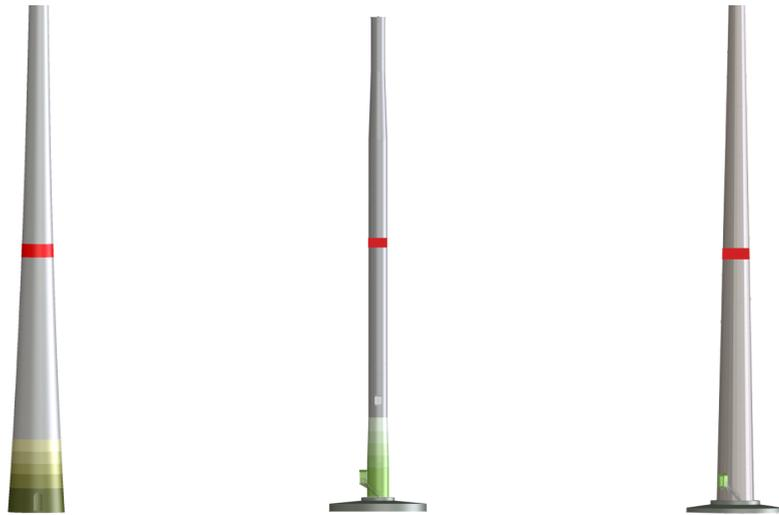
**Abb. 5: Farbliche Kennzeichnung am Hybridturm (links), am Stahlrohrturm (mittig) und am modularen Stahlurm MST (rechts)**
