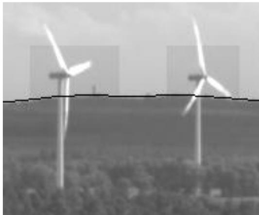
Abbildung 1: Automatisch generierte Ausschlussgebiete um Rotoren von WEA
