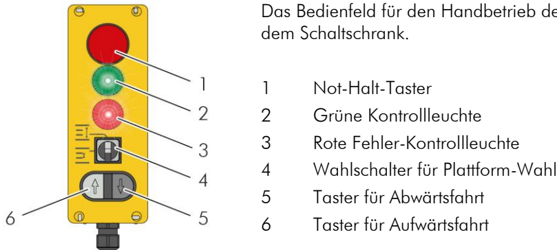
Abb. 11: Bedienfeld im Servicelift
