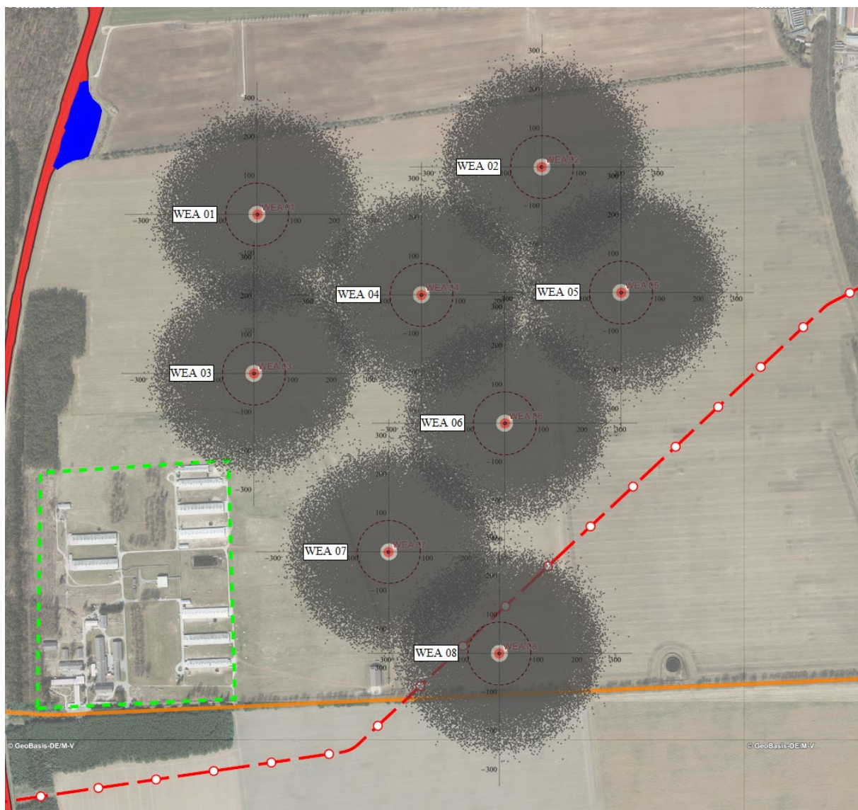
Abbildung 5: Auftreffpunkte bei Rotorblattbruch. Rotorblattradius schwarz gestrichelt.
