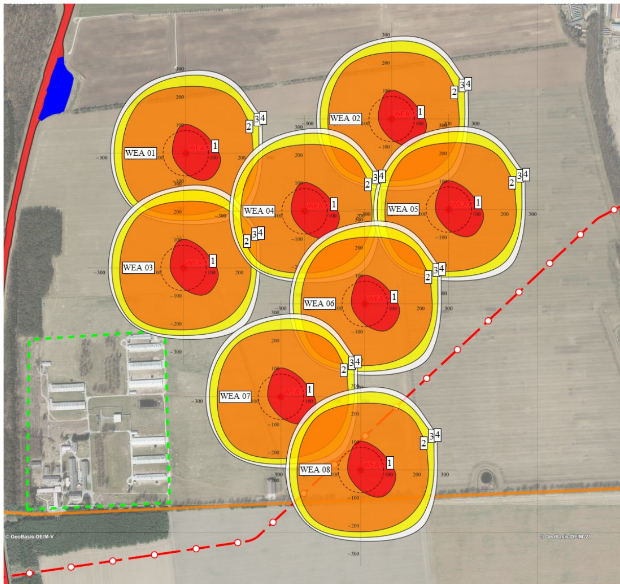
Abbildung 6: Trefferhäufigkeiten [1/m 2 ] bei Rotorblattbruch. Rotorblattradius schwarz gestrichelt.
