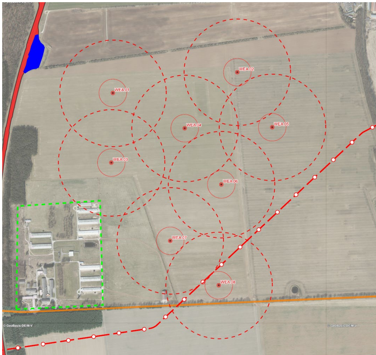
Abbildung 2: Gefährdungsradius Eisabwurf - rot gestrichelt ( v = 18,8 \text{ m/s} ).
