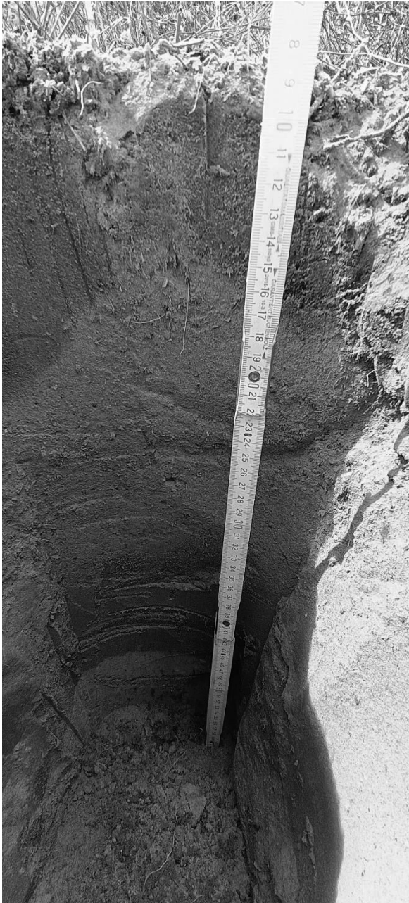
Bild 2 Schurf bis ca. 50 cm Tiefe bei WEA6
