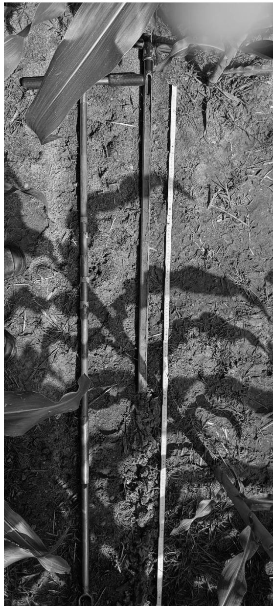
Bild 2 Bohrung mit Pürkhauer und Edelmann-Bohrer
