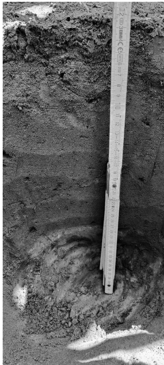
Bild 2 Schurf Oberboden bei WEA1
