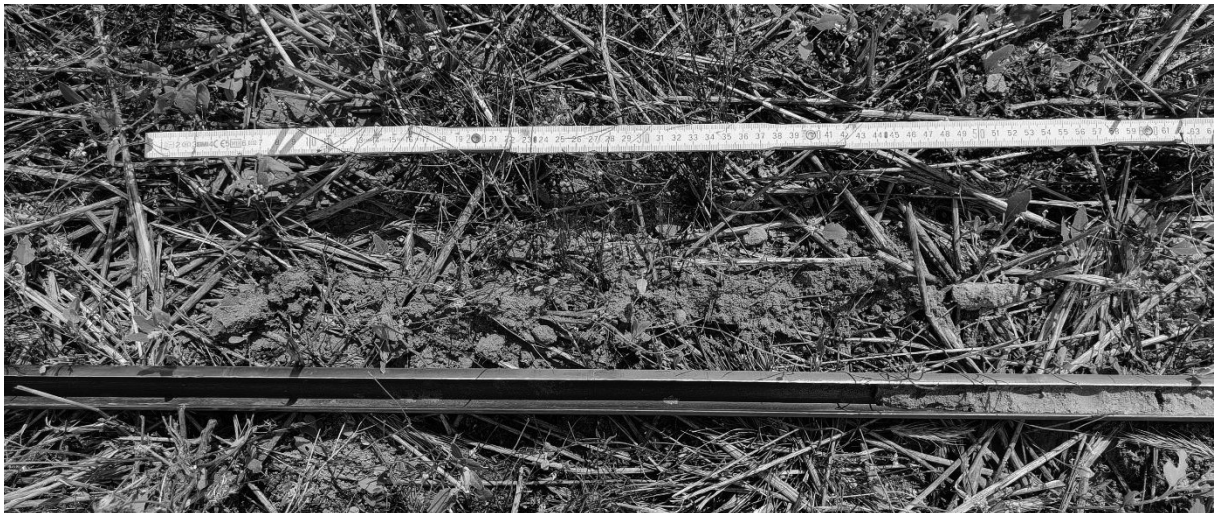
Bild 3 Bohrstock mit Kernverlust von 0 bis ca. 45 cm
