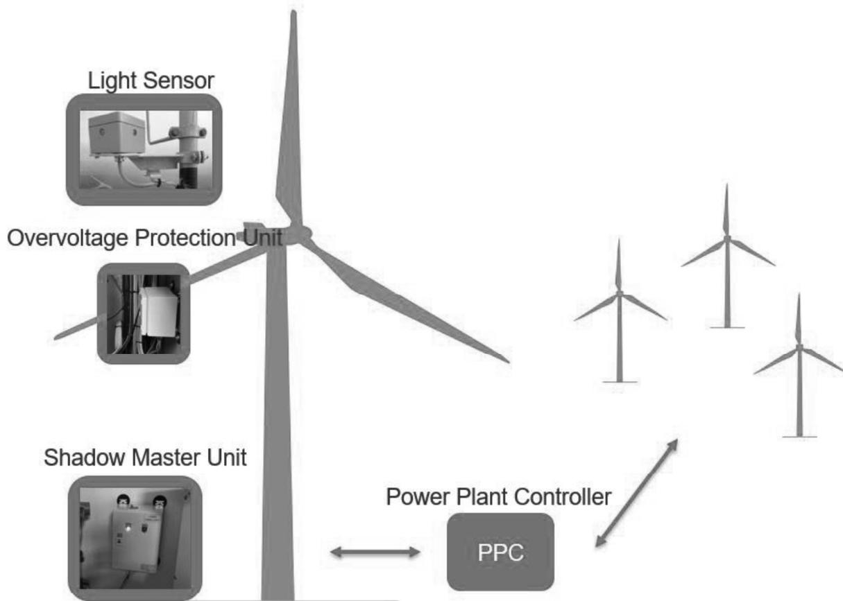
Abbildung 13-1: Prinzipskizze „Einbindung in die VestasOnline™ Architektur
