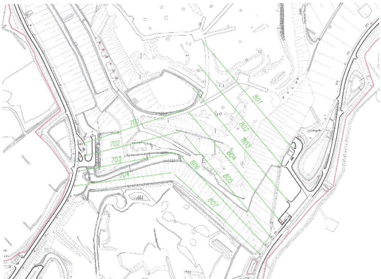
Abb. 1 Auszug aus dem Lageplan der Messlinien, u.a. in Sickerwassersammlern (hellgrüne Linien) [U1]
