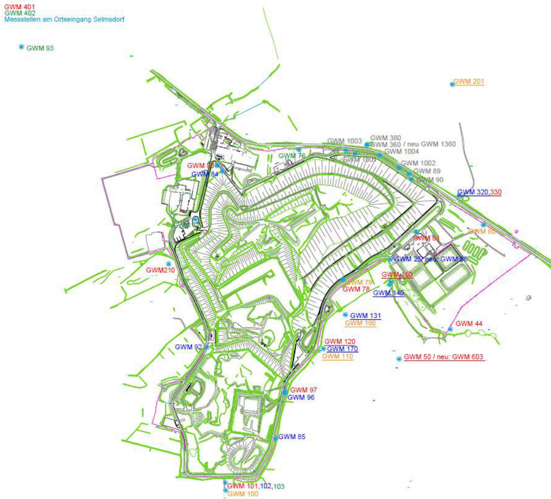
Abbildung 11: Grundwassermessstellennetz der Deponie Ihlenberg (rot: GWL 1.1, blau: GWL 1.2, gelb: GWL 1.3, grün: GWL 3, grau: Sondermessnetz Bockholzberg /8/
